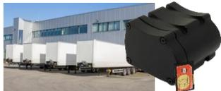
Anhänger Ortung mit integrierten Antennen und Start/ Stop Funktion. Batterie Lebensdauer bis 4 Jahre.
